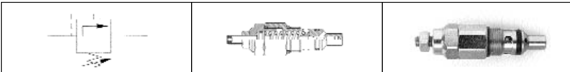
VALVOLA DI MASSIMA PRESSIONE K (CAMPO DI TARATURA 150-300 bar TARATURA STANDARD 200 bar) COD. 803065
